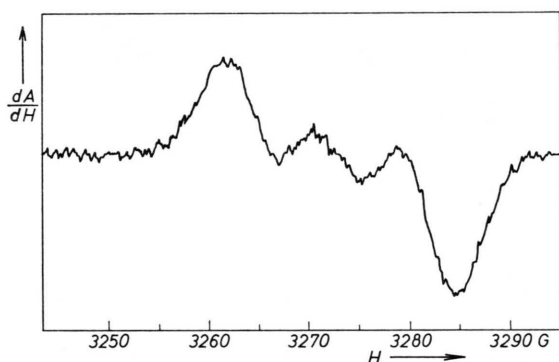
Abb. 4. ESR-Spektrum des \text{SbCl}_5 -oxydierten NIPCA ( 2 \cdot 10^{-4} m) in Methylenchlorid bei Raumtemperatur; 9,21 GHz.
